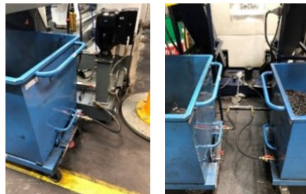
Abbildung 5: Rückführung von Kühlschmierstoffen
